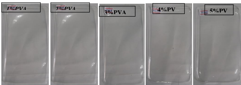
Figure 7: The photographs of (a) PVA-1 (b) PVA-2 (c) PVA-3 (d) PVA-4 (e) PVA-5 films
